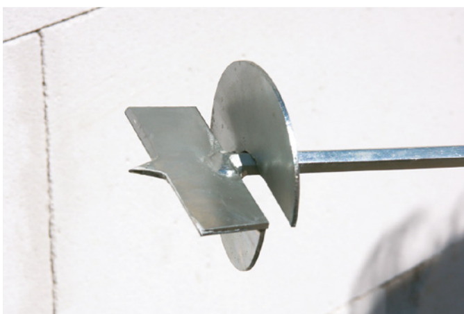
Na vytvoření kapsy použijeme plochý vrták.
